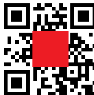
Obrázek 16: Poškození kódu s korekcí chyb typu H
