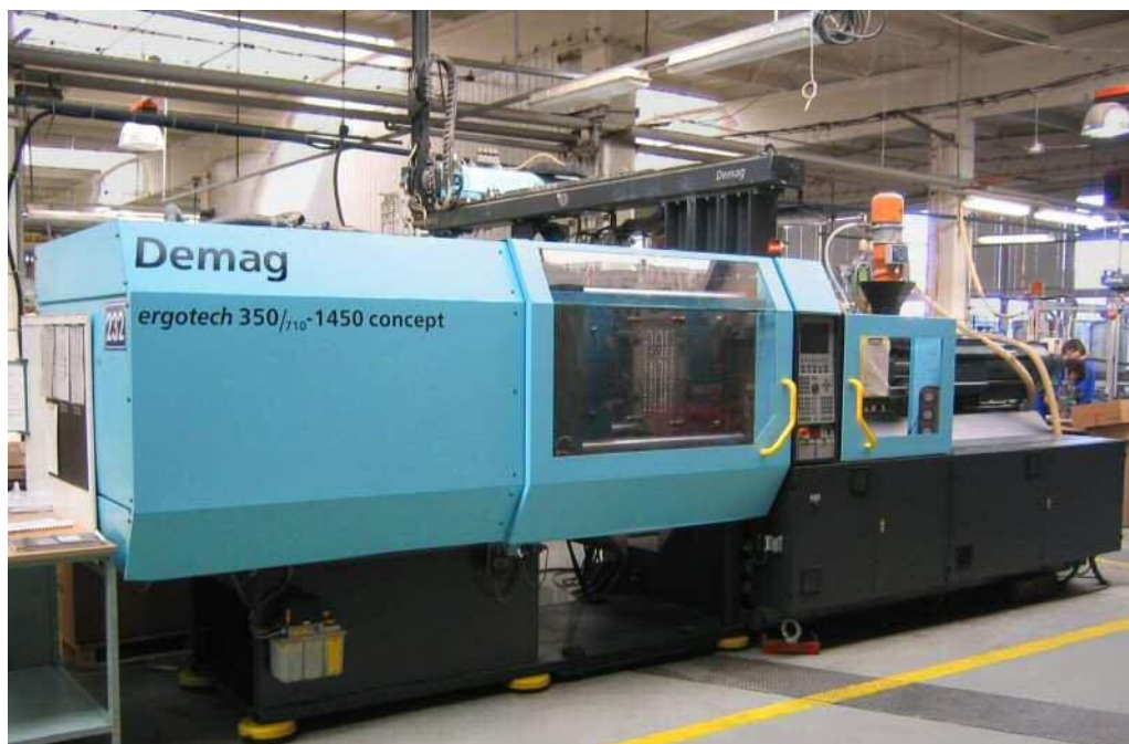
Obrázek č. 9: DEMAG vstříkovací lis ve firmě BTF Blatná s.r.o. (San Reo Trade, 2014)
