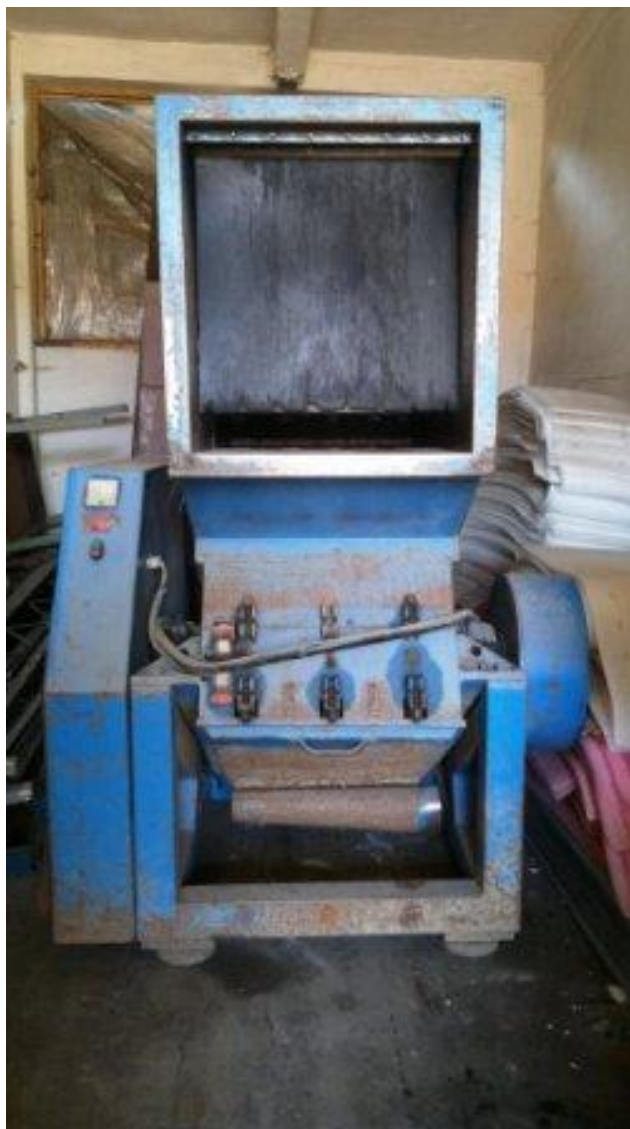
Obrázek č. 8: Drtič plastů Terier 400/600 (San Reo Trade, 2014)
