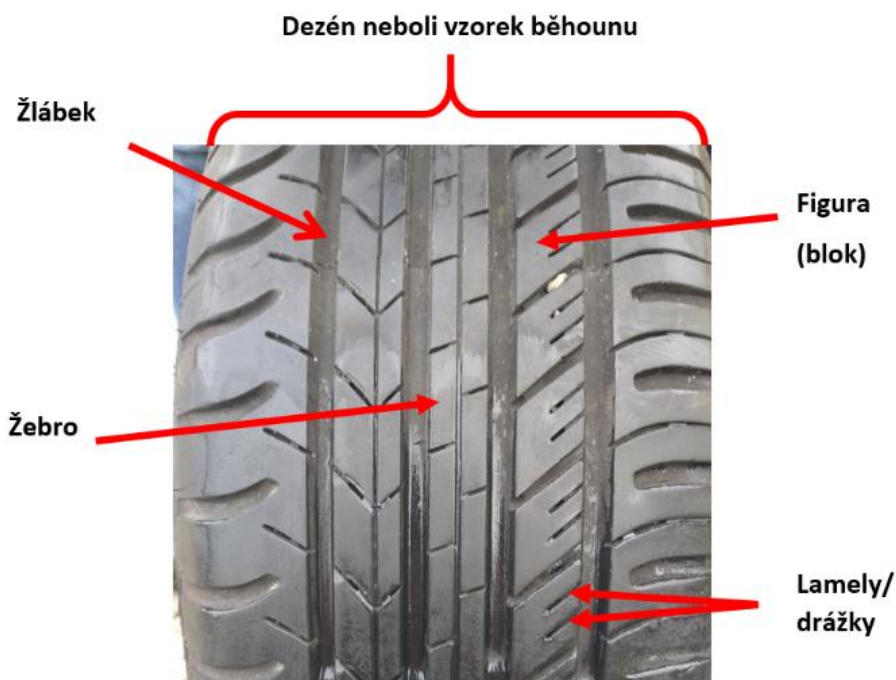
Obrázek 2 Popis běhounu pneumatiky. Zdroj: Vlastní zpracování
