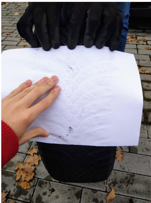
Obrázek 17 Tvorba otisku pneumatiky pomocí tempery a papíru. Zdroj: Vlastní zpracování
