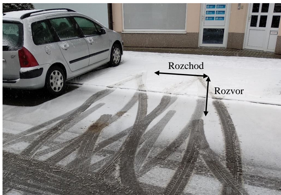
Obrázek 5 Otáčení vozidla couváním s vyznačeným rozchodem a rozvorem. Zdroj: Vlastní zpracování
