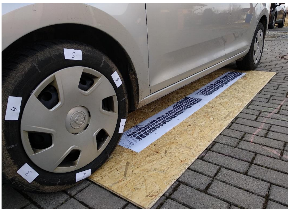
Obrázek 6 Technika kontrolního měření obvodu pneumatiky. Zdroj: Vlastní zpracování
