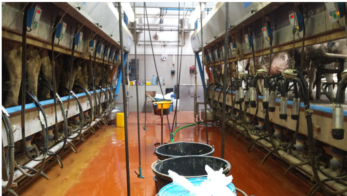
Obr. č. 8. Paralelní dojírna v průběhu dojení – pohled od čekárny
