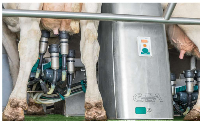
Obrázek č. 17 - Nasazená struková návlečka u kruhové dojírny DairyProQ (Agropress.cz, 2019d)
