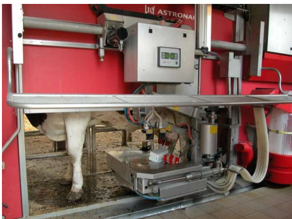
Obrázek č. 18 - Dojící robot Lely Astronaut na farmě v Pacově (Dojeni-roboty.cz, 2009)
