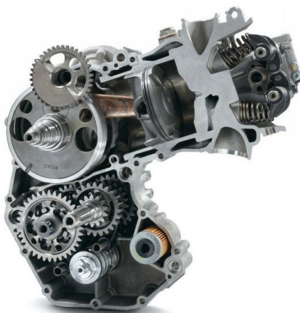
Obr. 4 Řez motorem Husaberg FE 570[11]
