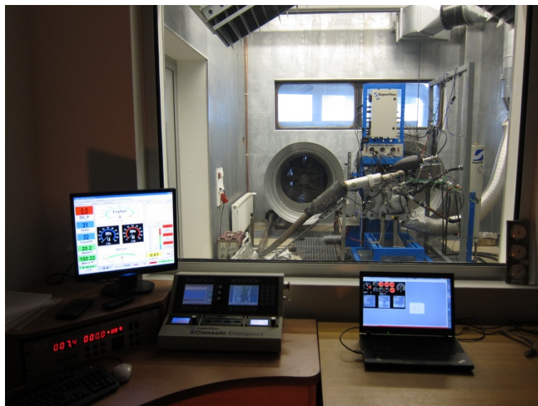
Obr. 6 Pohled z velína zkušebny Superflow SF-902
