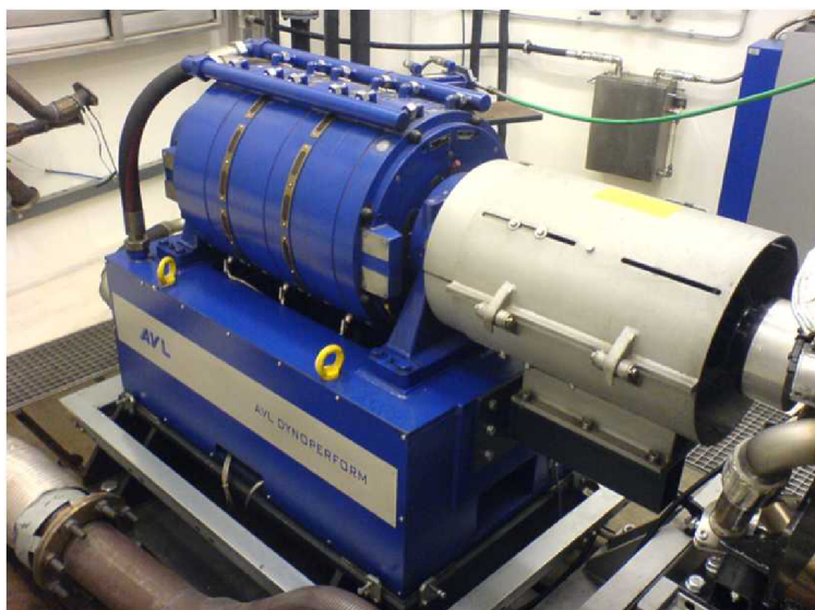
Obr. 16 Vířivý dynamometr AVL DP 500
