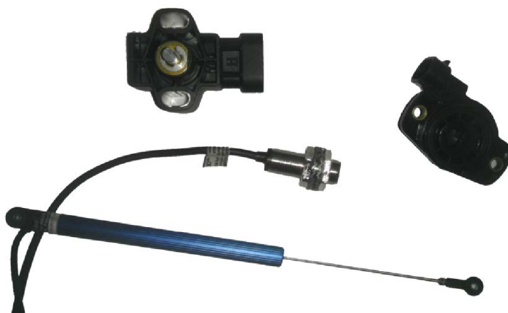
Obr. 12 Snímače polohy, rychlosti, zrychlení
