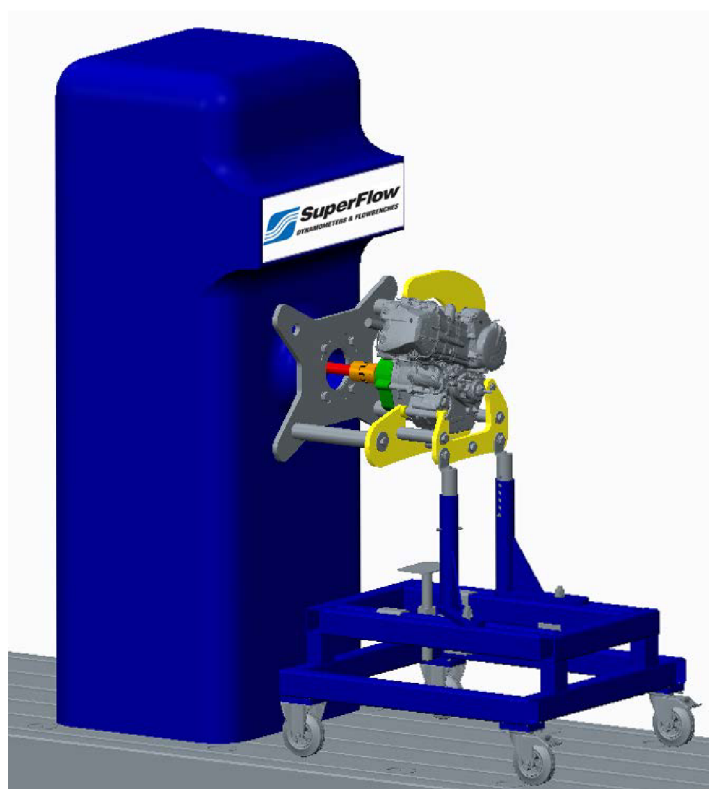
Obr. 32 Uložení motoru na dynamometr
