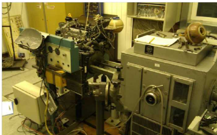
Obr. 18 Aktivní elektrický dynamometr DS 736-4V
