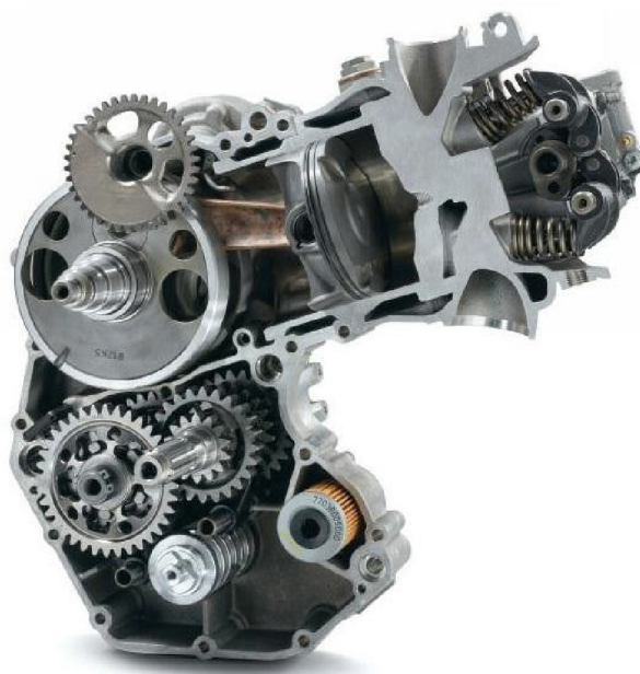
Obr. 4 Řez motorem Husaberg FE 570[11]
