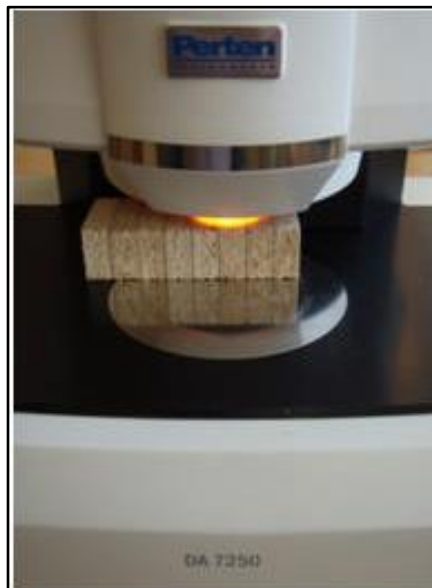
Obrázek č. 20: Analýza vzorku NIR zářením (Perten, 2014)
