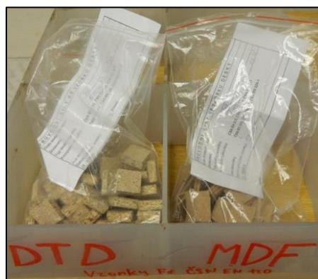
Obrázek č. 14: Vzorky DTD a MDF pro perforátorovou metodu
