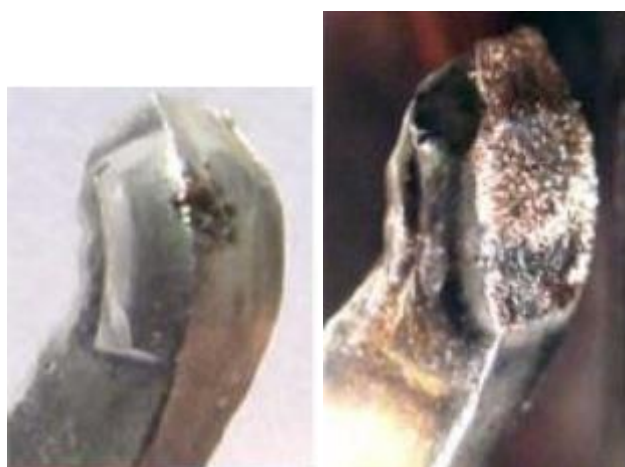
Obr. 15 - Mechanické poškození kontaktů [12]
