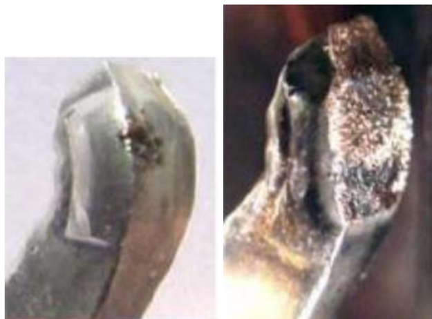
Obr. 15 - Mechanické poškození kontaktů [12]
