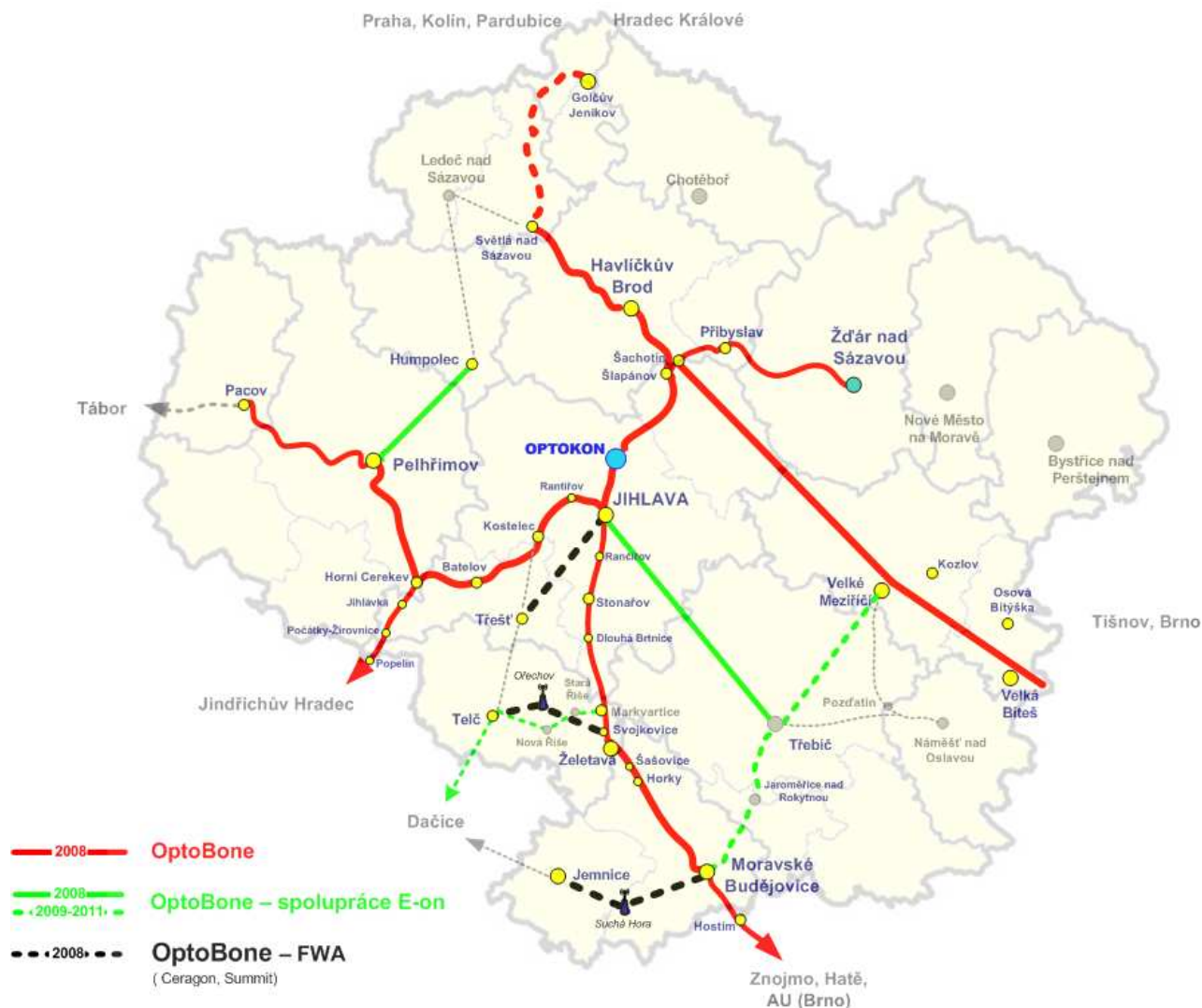
Obrázek 9 Topologie sítě OptoNet
