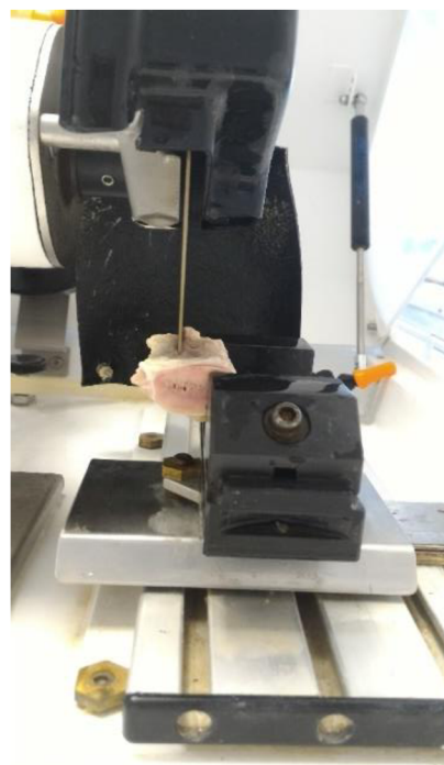
Obrázek 7: Provedení prvního z dvojice rovnoběžných řezů
