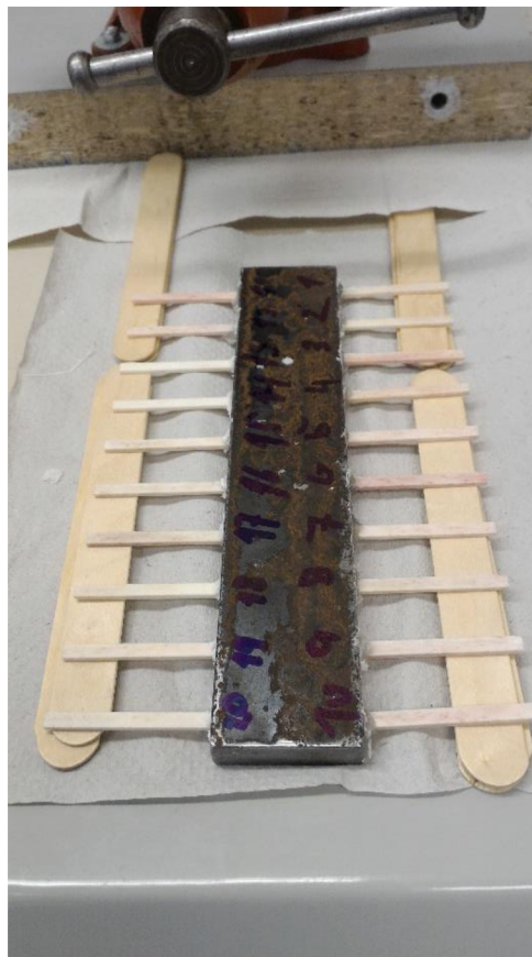
Obrázek 16: Zalití vzorků pryskyřicí
