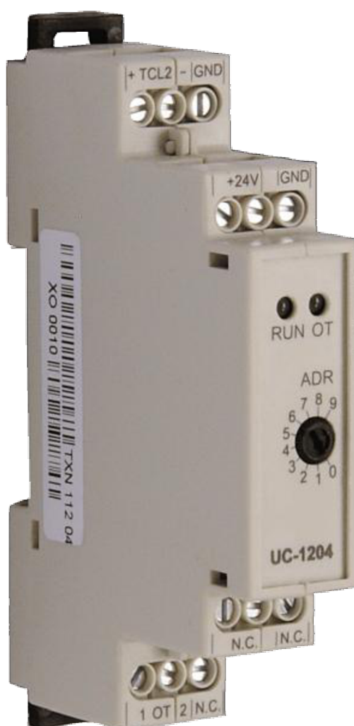
Obrázek 3.3: Periferní modul UC-1204 pro komunikaci s kotlem s rozhraním OpenTherm [8]
