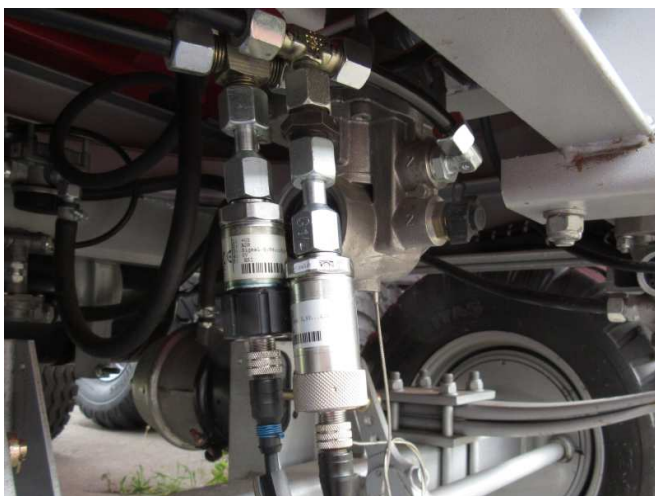
Obr. 6.1 – Tlakové snímače před a za zátěžovým regulátorem tlaku brzd přívěsu Zdroj: vlastní foto
