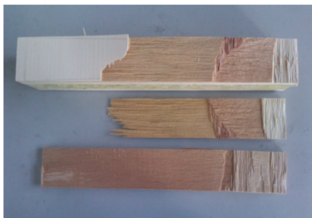
Obr. 27: Pevnost lepené spáry dlátovou zkouškou
