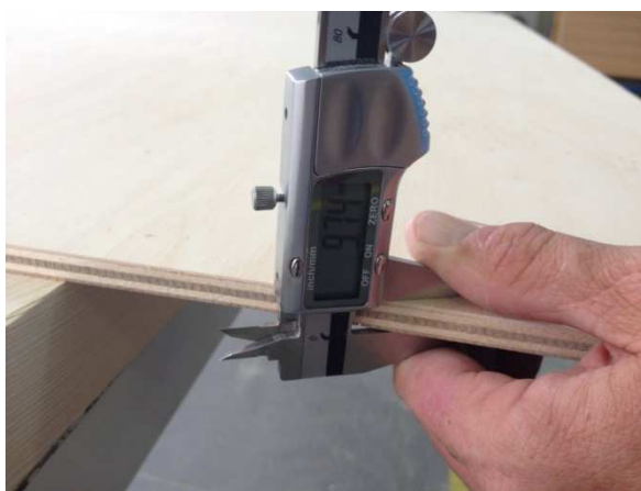
Obr. 5: Překližka s okrasnou smrkovou dýhou s reprodukovatelnou texturou
