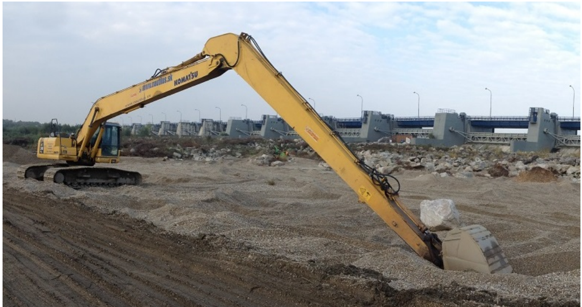
Obr. 11 Pásový bager s predĺženým ramenom SUPERLONGFRONT Zdroj: NAUTILUS - fotodokumentácia.
