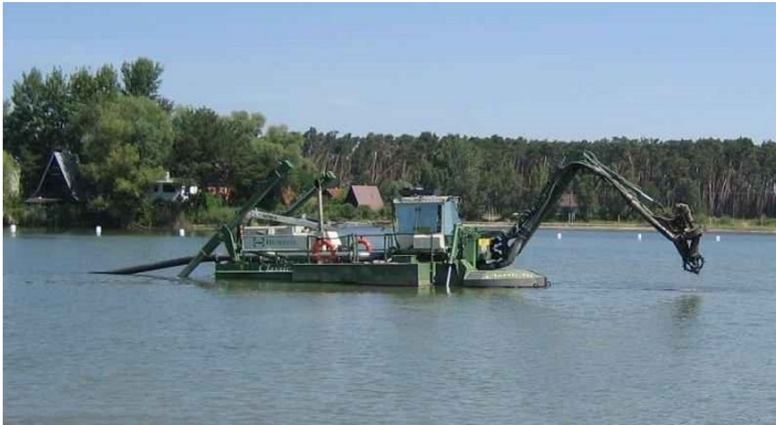
Obr. 12 Plávajúci sací bager USB 20J Zdroj: NAUTILUS - fotodokumentácia.
