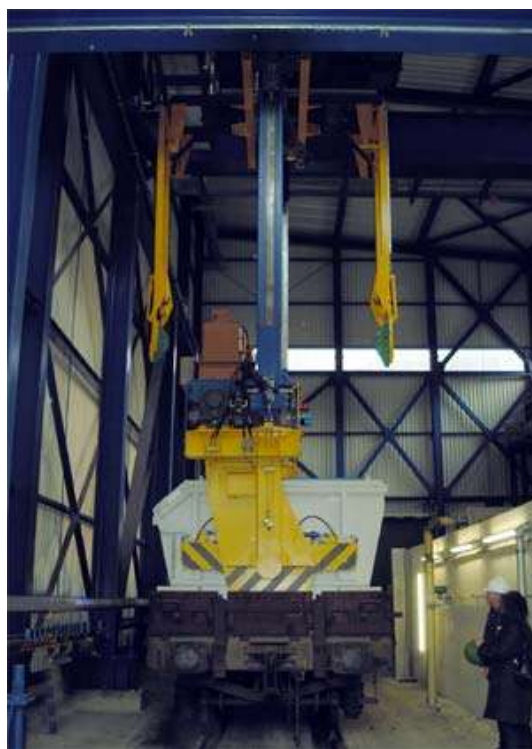
Obr. 21 Manipulácia s Mulden kontajnerom [25]
