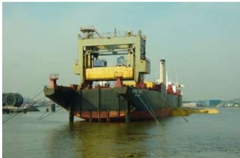
Obr. 51 loď systému LASH [47]
