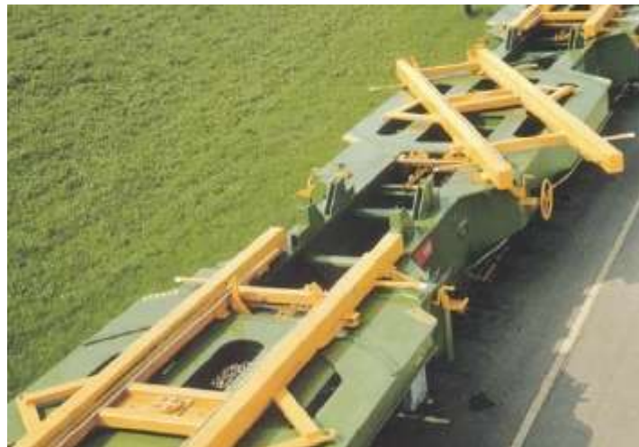
Obr. 19 železničný vozeň pre ACTS kontajner [35]
