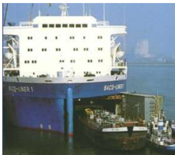
Obr. 53 Loď systému BACO-LINER[47]
