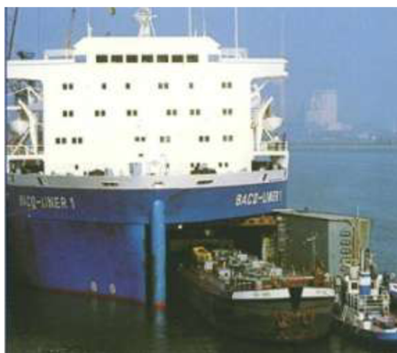
Obr. 53 Loď systému BACO-LINER[47]
