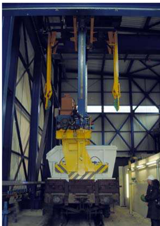
Obr. 21 Manipulácia s Mulden kontajnerom [25]
