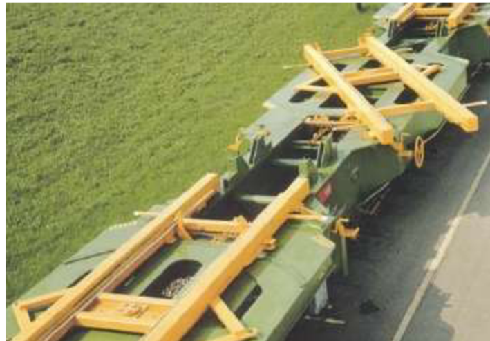
Obr. 19 železničný vozeň pre ACTS kontajner [35]
