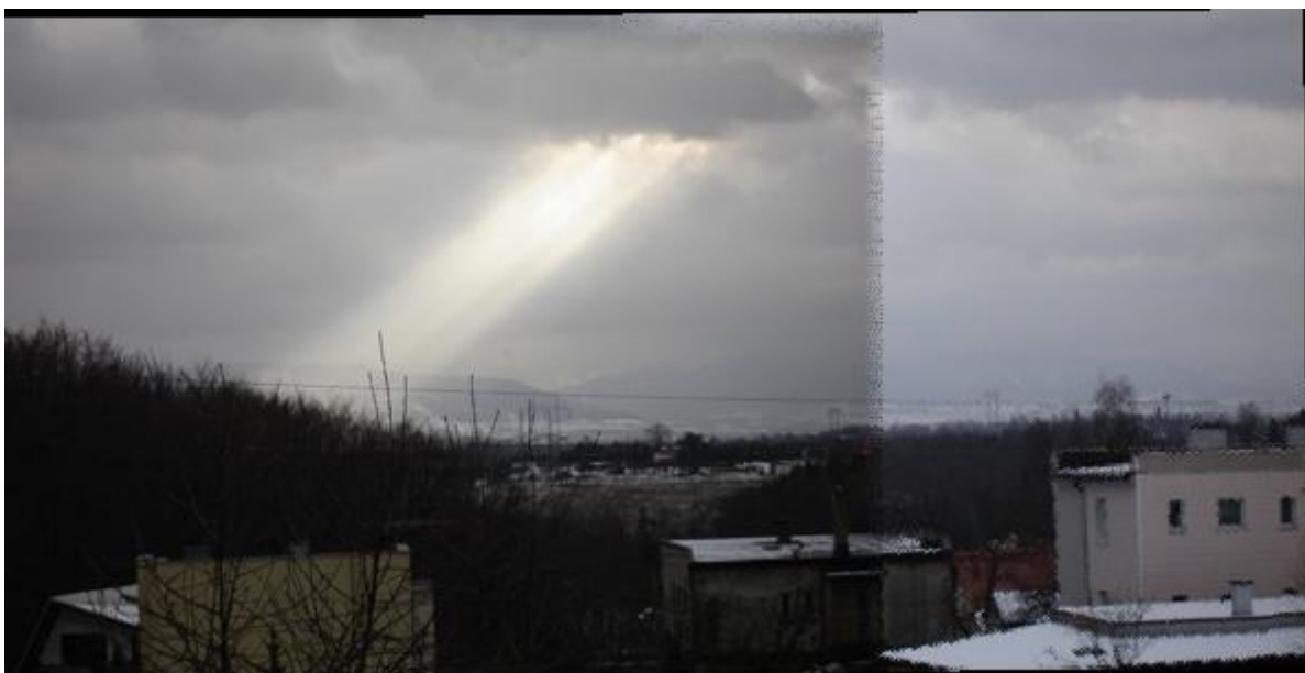
Obrázek 8.3: Vyhlazení přechodu bez vyrovnání jasu
