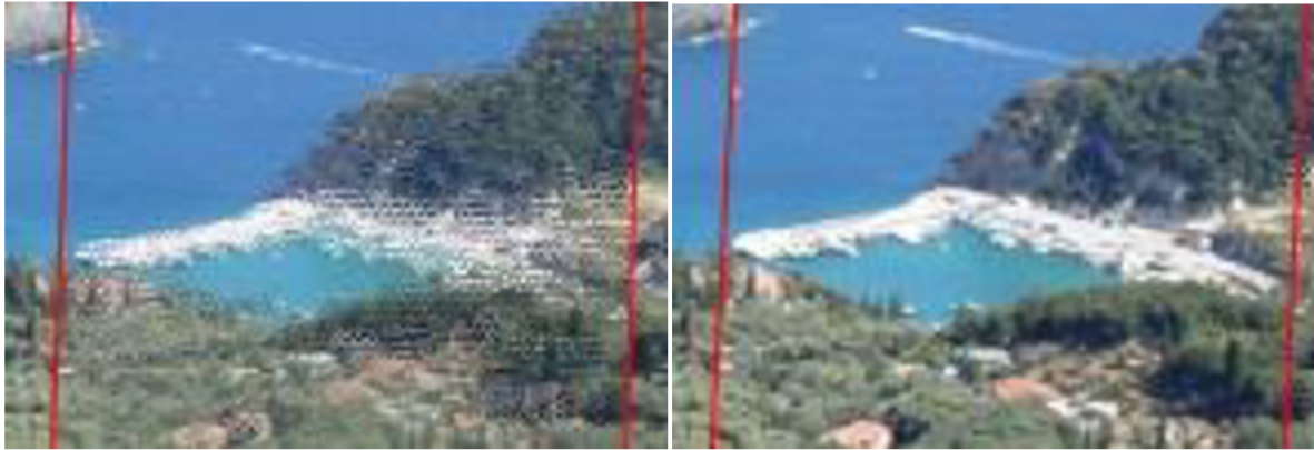
Obrázek 8.2: Přejchod mezi dvojicí obrázků a) průměrování barev, b) přechod s originálem
