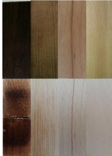
Obr. 26: Změny povrchu během umělého stárnutí. Horní zkušební vzorky (termická úprava 210°C, 190°C, 170°C, reference) na začátku testu ve srovnání po 1000 hodinách (Pelzerová, 2017).
