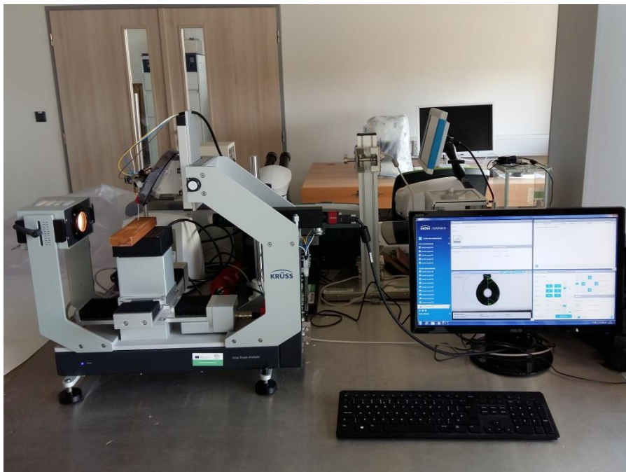
Obr. 8: Měření kontaktního úhlu smáčení na přístroji goniometr (Pelzerová, 2017).
