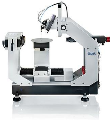
Obr. 12: Přístroj goniometr (KRÜSS GmbH, 2017).
