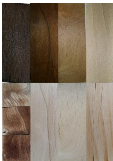
Obr. 25: Změny povrchu během umělého stárnutí. Horní zkušební vzorky (termická úprava 210°C, 190°C, 170°C, reference) na začátku testu ve srovnání po 1000 hodinách (Pelzerová, 2017).
