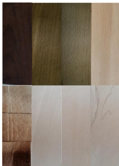
Obr. 24: Změny povrchu během umělého stárnutí. Horní zkušební vzorky (termická úprava 210°C, 190°C, 170°C, reference) na začátku testu ve srovnání po 1000 hodinách (Pelzerová, 2017).
