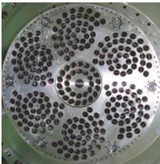
Obr. 27: Pohled na hořákové trysky Multi – cluster společnosti MHI, převzato z [57].
