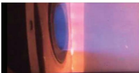
Obr. 15: Plamen zemního plynu a vodíku, převzato z [32].
