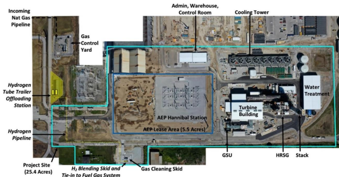
Obr. 32: Letecký pohled na areál elektrárny s příslušenstvím a naznačeným tokem vodíku, převzato z [64].
