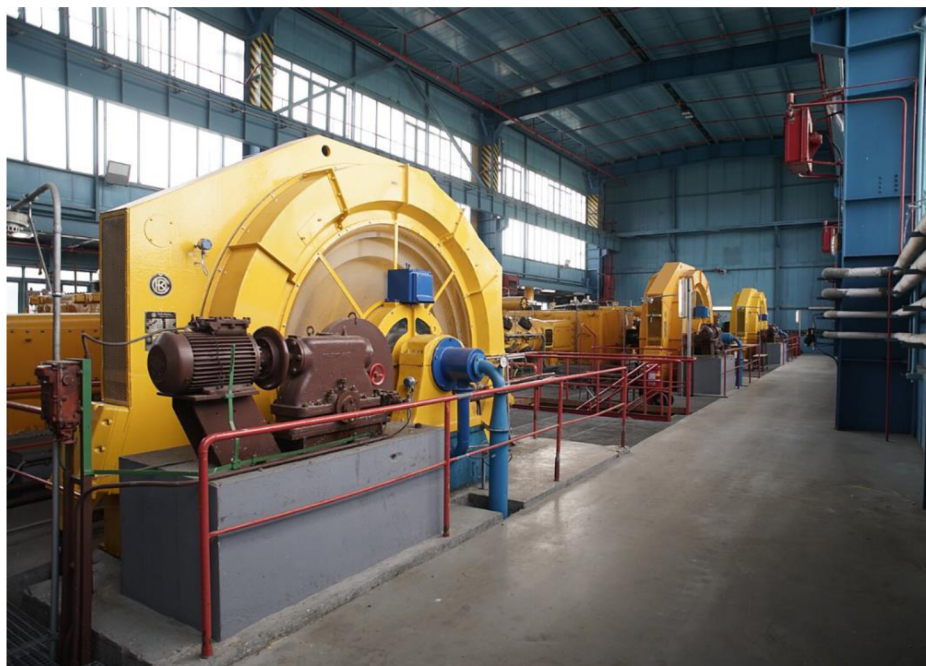
Obr. 12: Kompresory pro vtláčení zemního plynu do zásobníků v ČR, převzato z [39].
