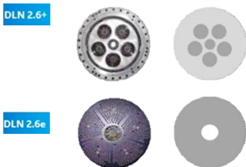
Obr. 23: Porovnání hořáků DLN 2.6+ a DLN 2.6e, tmavě šedá plocha znázorňuje plochu proudění paliva a vzduchu, světle šedá pouze vzduchu, převzato z [45].
