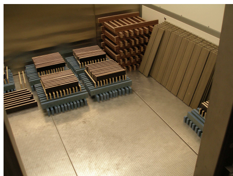
Vzorky připravené v klimatizační komoře
