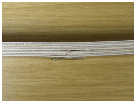
Detail lomu u zkušebních vzorků PDP
