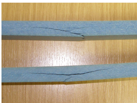
Detail lomu u zkušebních vzorků MDF
