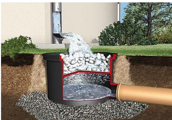
Obr.4.3.3 (2) Filtrační nátoková šachta [11]
