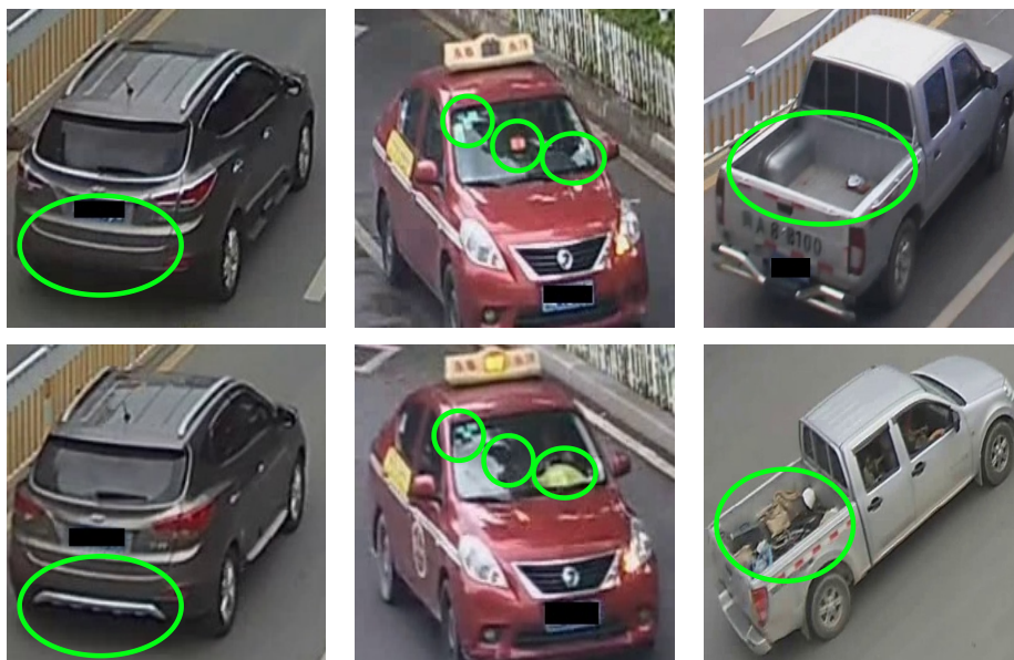
Obrázek 3.4: Vozidla, která mají globální vzhled stejný, ale liší se v lokálních oblastech, které rozlišují identitu vozidla.
