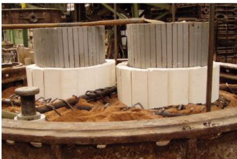
Obrázek 12: Dva nálitky, částečně zaformované a obložené izolací IZOSPAR [12]
