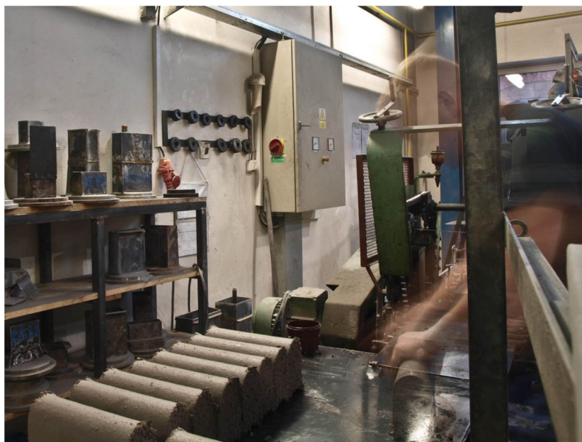
Obrázek 67: tažení vzorků směsi PP 1.1
