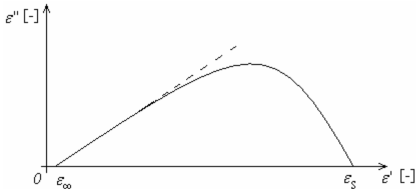
Obr. 1.5 Davidsonův–Coleův diagram s jedním distribučním parametrem
