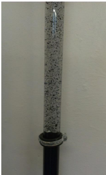
Obr. 7. 6 Praní adsorpčního materiálu Filtrasorb F100 [autor]
