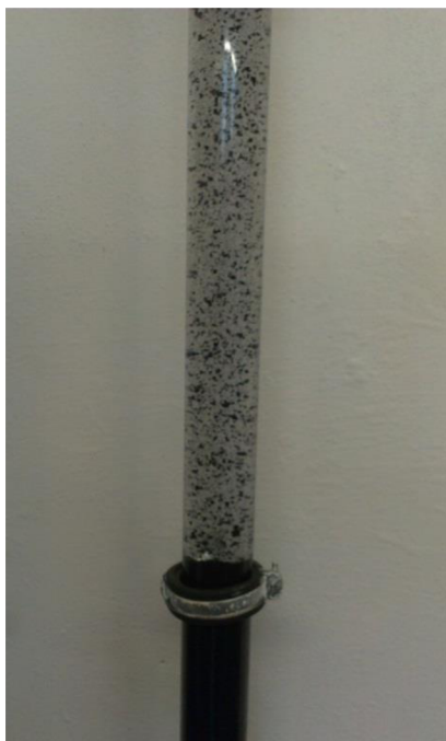
Obr. 7. 6 Praní adsorpčního materiálu Filtrasorb F100 [autor]
