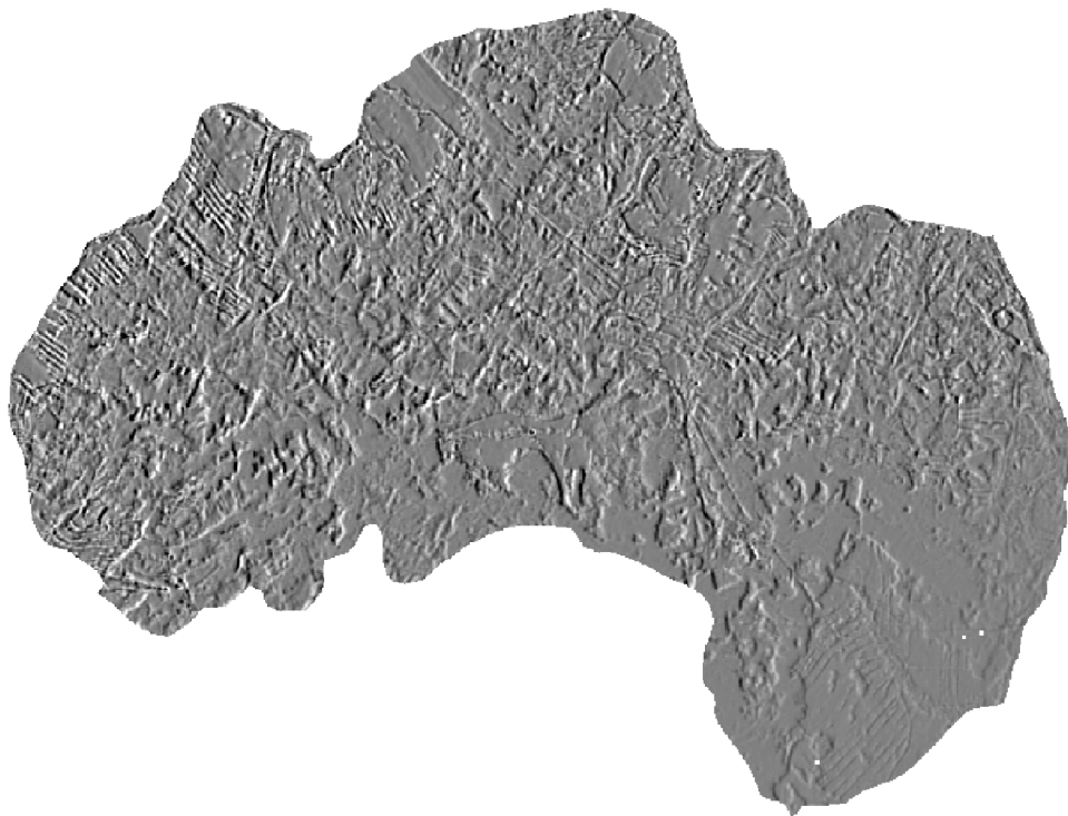
Obr. č. 22 – filter CED s jednou iterací aplikovaný na pásmo B8 snímku Sentinel 2 ze dne 6. listopadu 2022
