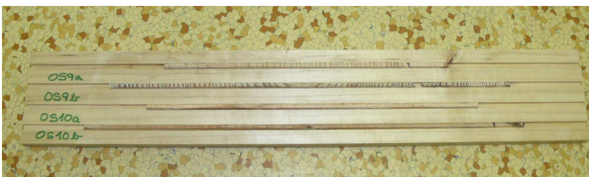
Foto 6: Před vlastním měřením šířek letokruhů je nejdříve potřeba vývrtý nalepit na dřevěnou podložku a následně zbrousit (12-12-2009).
