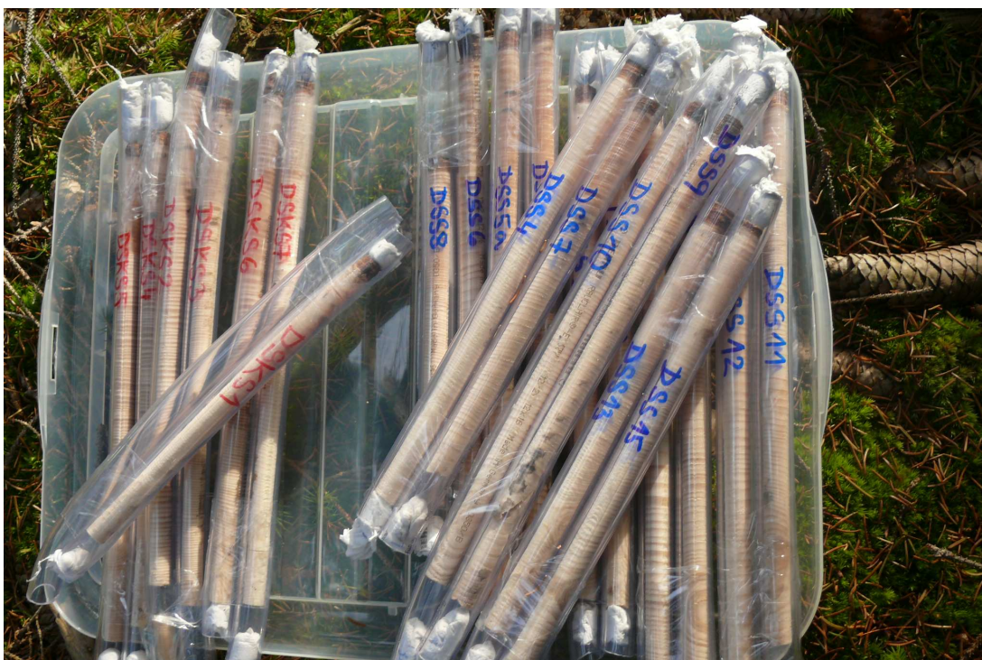
Foto 4: Smrkové vývrty určené k denzitometrické analýze dřeva (05-11-2010).
