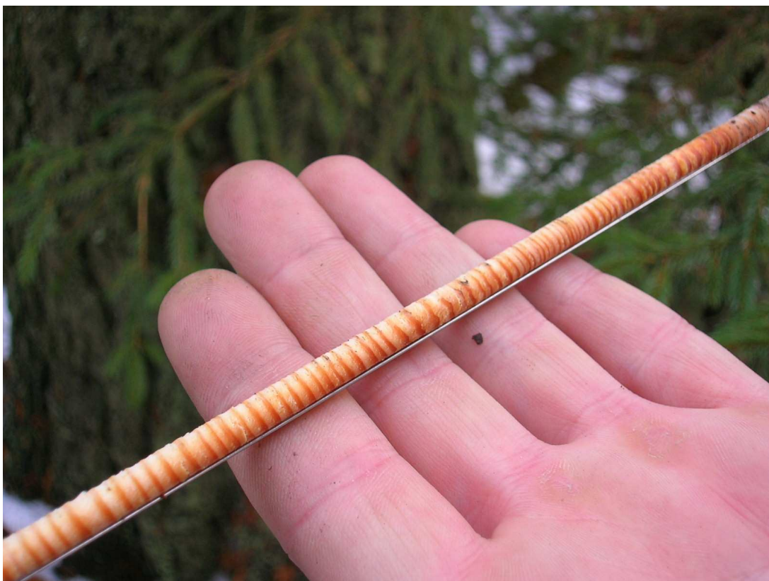
Foto 3: Modřínový vývrt odebraný Presslerovým nebozezem pro dendrochronologickou analýzu šířek letokruhů (10-01-2008).
