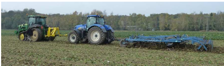
Obrázek 5: Měřicí souprava. Zleva: tažný traktor John Deere 8320RT, měřicí rám, měřicí tyč, tažený traktor New Holland T7050 pro zvedání a spouštění kypřiče, kypřič Köckerling Gruber Vario s pracovním záběrem 5 m.
