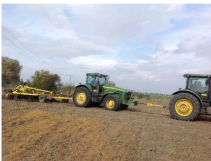
Obrázek 4: Měřicí sestava. Z prava: tažný traktor John Deere 8345R, tahová měřicí tyč, tažený traktor John Deere 8220 pro nesení a ovládání kypřiče, kypřič Ecoland EO 4000.
