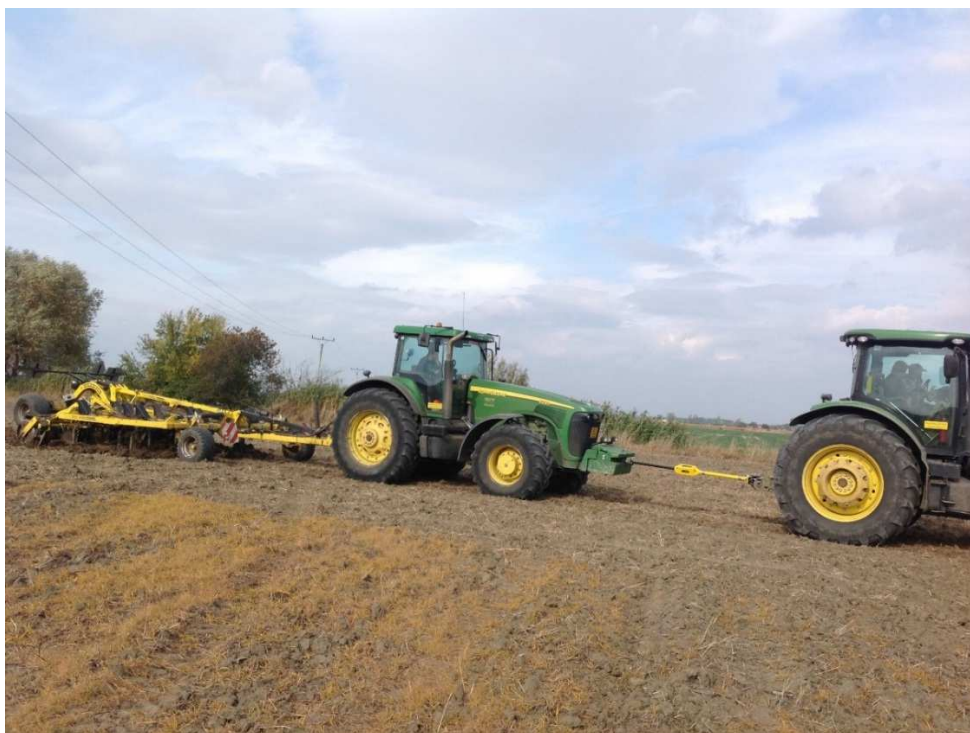
Obrázek 27: Měřicí sestava. Z prava: tažný traktor John Deere 8345R, tahová měřicí tyč, tažený traktor John Deere 8220 pro nesení a ovládání kypřiče, kypřič Ecoland EO 4000.
