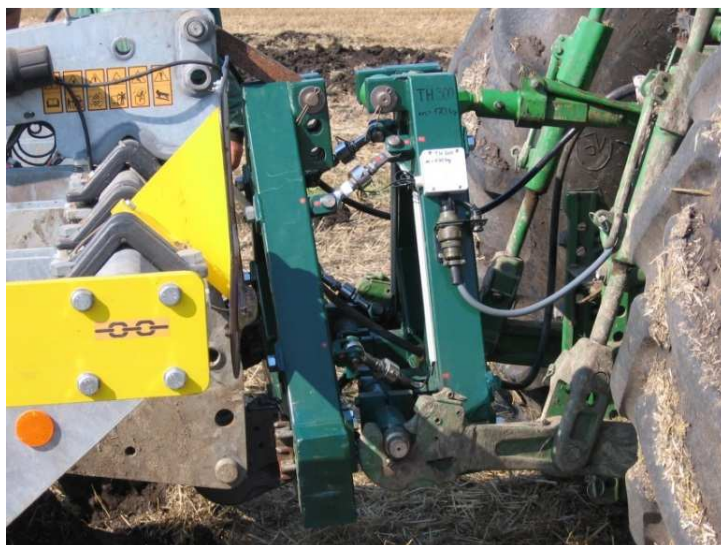
Obrázek 7: Praktické provedení zařízení na měření tahových sil označené jako TH 300.
