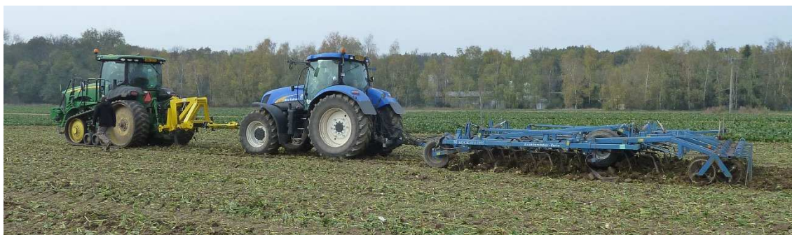
Obrázek 30: Měřicí souprava. Zleva: tažný traktor John Deere 8320RT, měřicí rám, měřicí tyč, tažený traktor New Holland T7050 pro zvedání a spouštění kypřiče, kypřič Köckerling Gruber Vario s pracovním záběrem 5 m.
