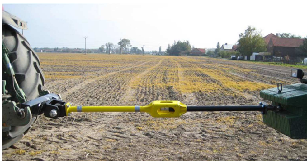
Obrázek 28: Měřicí zařízení (měřicí tahová tyč) mezi oběma traktory.
