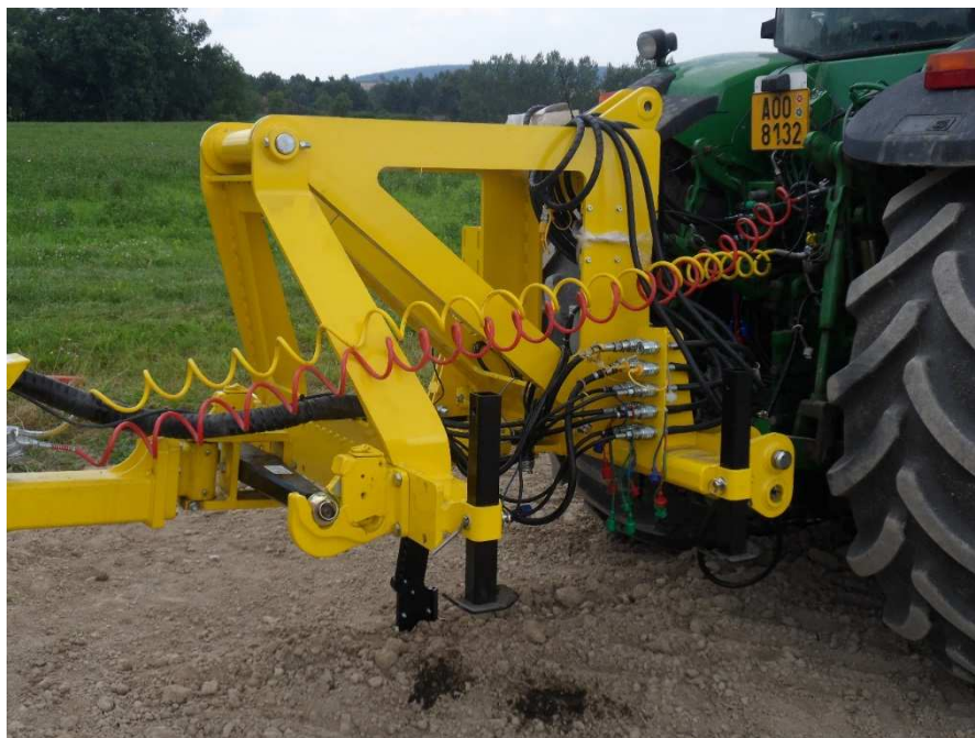
Obrázek 22: Reálné provedení měřicího rámu.
