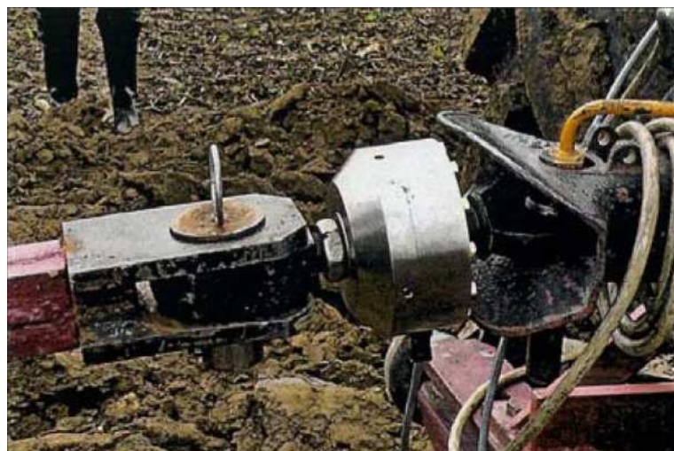
Obrázek 8: Tenzometrický snímač k měření tahové síly U 10 M (Pražan a Podpěra, 2011).
