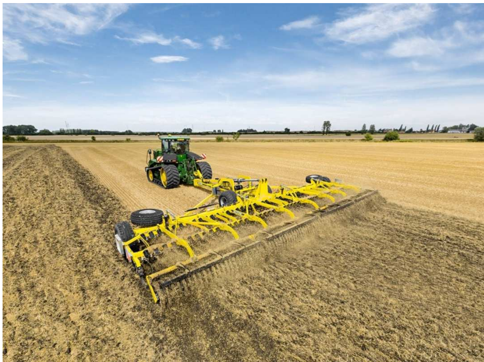
Obrázek 1: Moderní souprava na zpracování půdy - pásový traktor John Deere a talířový kypřič BEDNAR ATLAS AM 10000.
