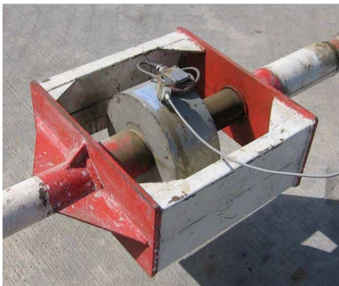
Obrázek 9: Tenzometrický snímač HBM ZA vestavěný v ochranné kovové kleci (Preč a kol., 2008).
