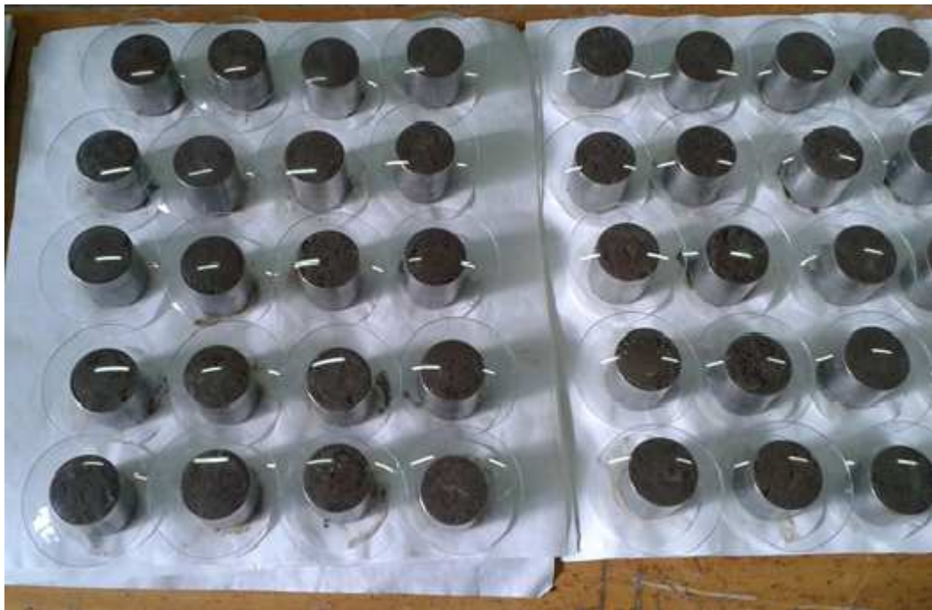
Obrázek 26: Kopeckého válečky na filtračním papíře s překrytou horní základnou hodinovým sklem.
