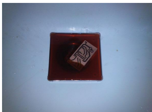
Obrázek č. 13 – Cuprexit v leptacím roztoku
