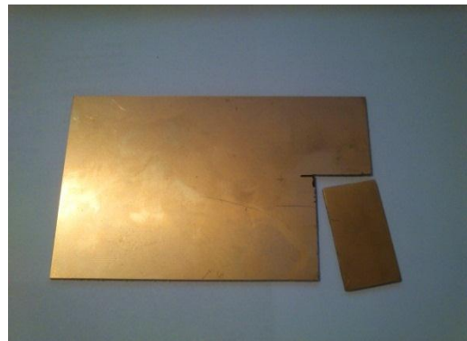
Obrázek č. 6 – Vyříznutá destička cuprexitu
