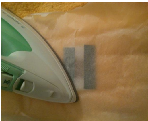
Obrázek č. 10 – Nažehlování toneru na cuprextit
