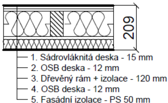
Obr. 12 Skladba rámové konstrukce – požadovaná hodnota
