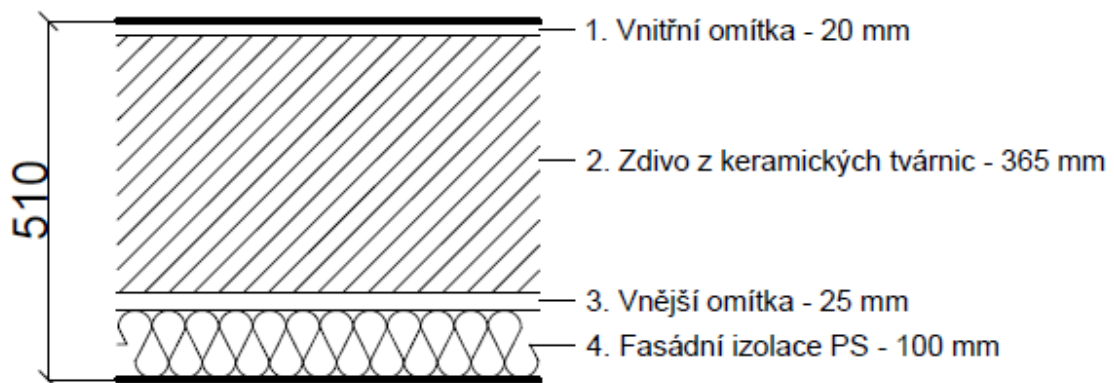
Obr. 6 Schéma konstrukce s izolací 100 mm
