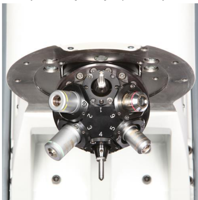
Obr. 1 Automatická šestipolohová revolverová hlava [5]
