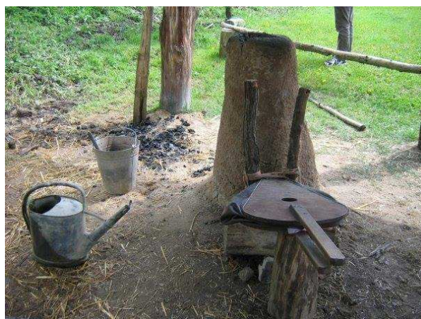
Ilustrace 6: pec na tavení železné rudy
