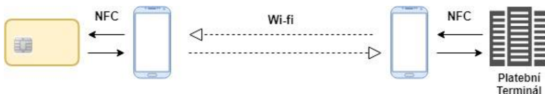
Obr. 17 Schéma relay útoku
