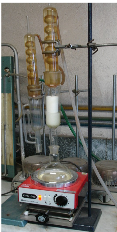
Obr. 19: Extrakce v Soxhletově přístroji
