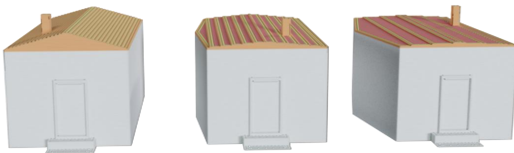
Obr. 7.1 – Kaskádovitá textura při tisku vertikálních úhlů (střech) - zleva 15°, 5° a 2,5°
