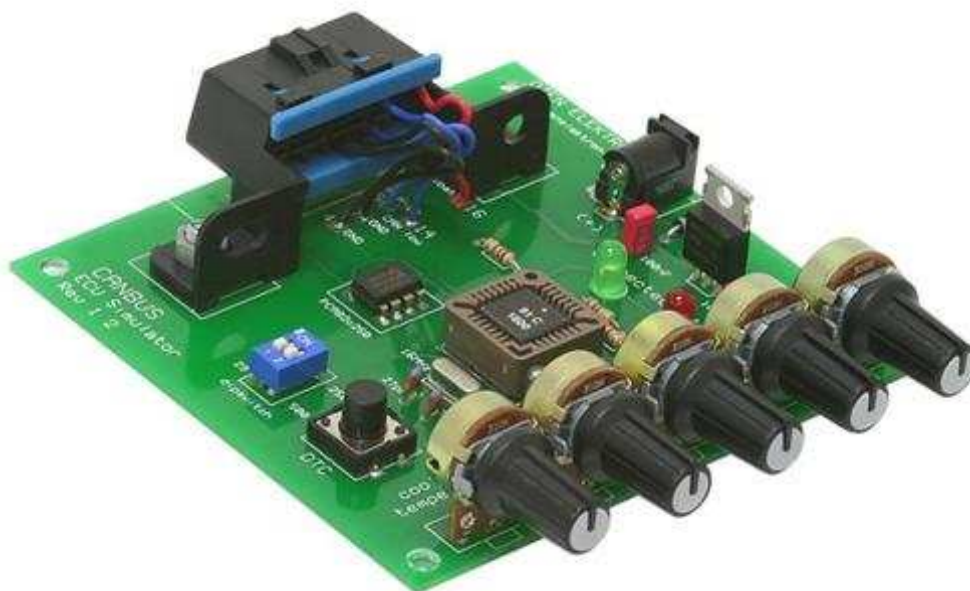
Obrázek 36: Simulátor řídicí jednotky mOByDic 1610, převzato z [22]
