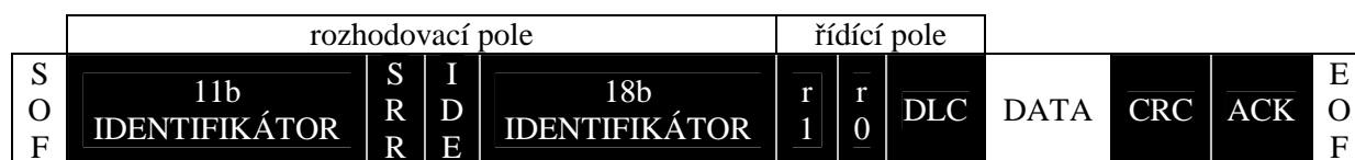
Obrázek 10: Rozšířený formát datového rámce CAN 2.0B dle [7]
