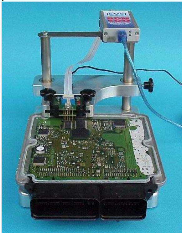
Obrázek 5: Komunikace ECU prostřednictvím BDM rozhraní, převzato z [20]
