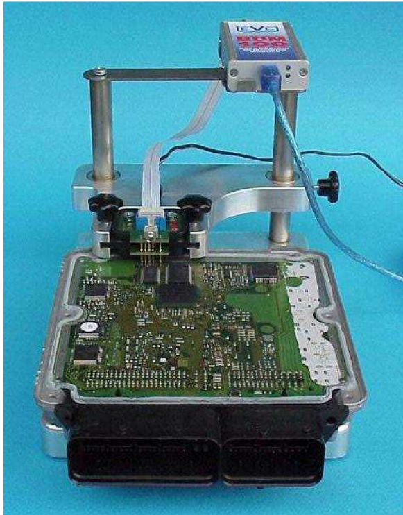
Obrázek 5: Komunikace ECU prostřednictvím BDM rozhraní, převzato z [20]
