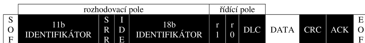
Obrázek 10: Rozšířený formát datového rámce CAN 2.0B dle [7]
