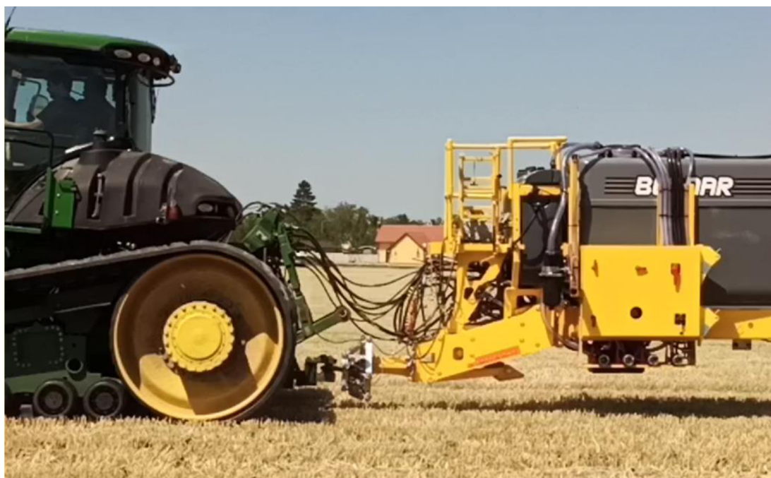
Obr. 34: Detail měřicího přípravku, pro tažné oko během měření.
