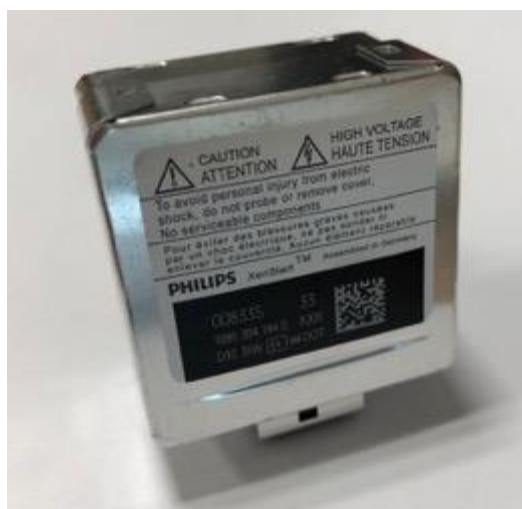
Obr. 36 - Xenonová výbojka D3S (spodní strana) [vlastní]
