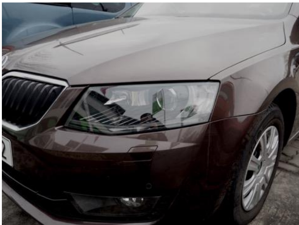
Obr. 35 - Škoda Octavia III. generace - bi-xenonový světlomet [vlastní]
