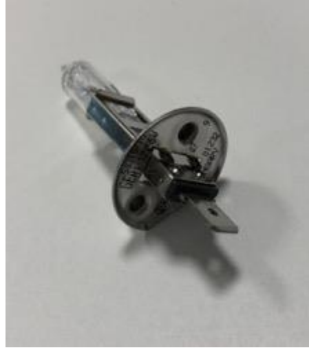
Obr. 34 - Halogenová žárovka H1 [vlastní]
