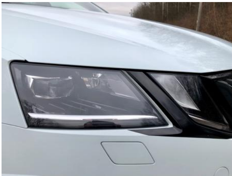
Obr. 38 - Škoda Octavia III. generace RS230 (facelift) - full-LED světlomet [vlastní]
