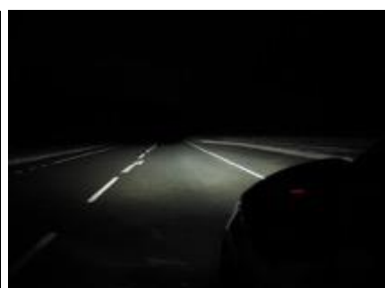
Obr. 60 - Pohled z vozidla_LED_č_potkávací_60 m [vlastní]
