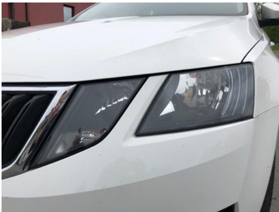
Obr. 32 - Škoda Octavia III.generace (facelift) - halogenový světlomet [vlastní]
