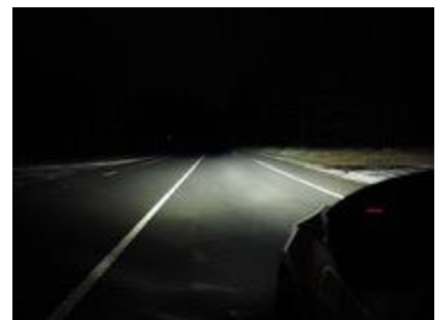
Obr. 70 - Pohled z vozidla_LED_č_potkávací_30 m [vlastní]
