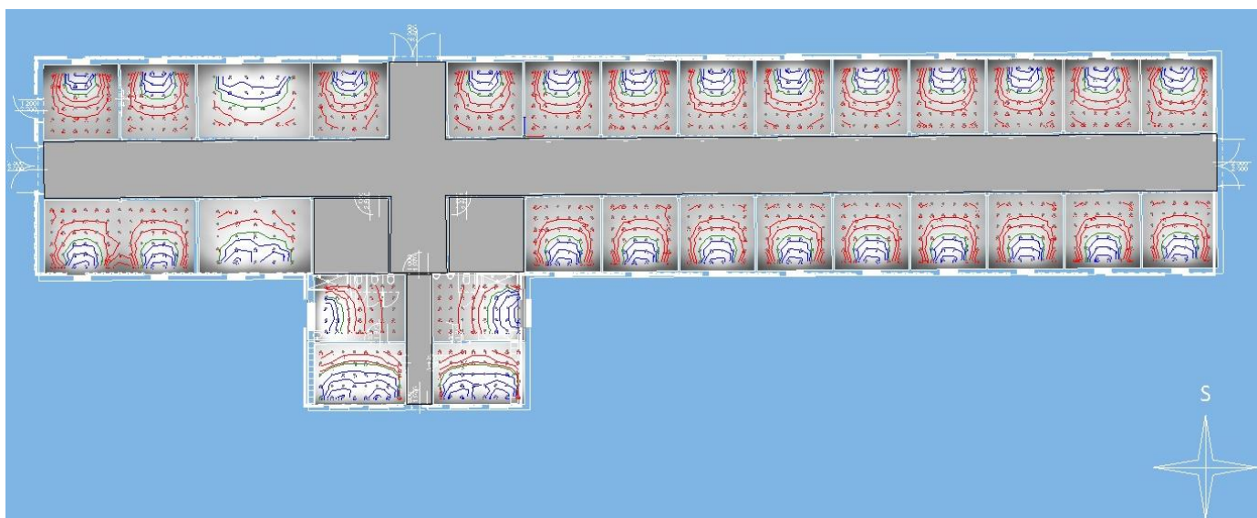
Obr. č. 8: Grafické zobrazení výpočtu denního osvětlení v celém objektu stájích v aplikaci Building Design (autor: Bc. Martin Bella)
