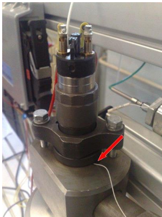
Obr. 27 Pohled na umístění snímače zdvihu jehly (vlastní zpracování)
