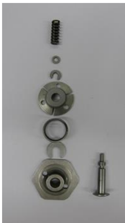
Obr. 46 Rozložená sestava originální kovy (vlastní zpracování)
