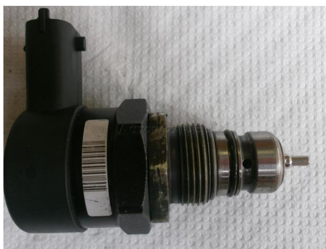
Obr. 24 Detailní pohled na DRV ventil (vlastní zpracování)
