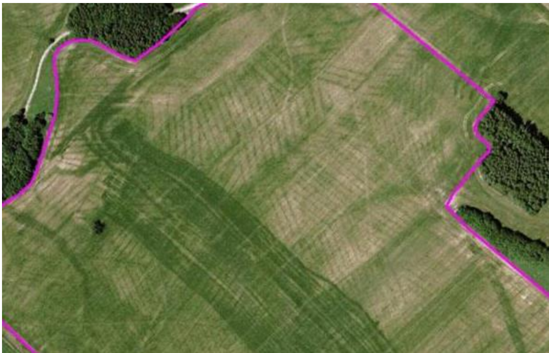
Obr. 4: Příklad identifikovaných ploch s viditelnou drenáží, [Zdroj: Tlapáková a kol., 2004]
