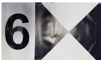
Obr. 7: Ilustrační vlícovací bod, [Fotografie: zpracování vlastní]
