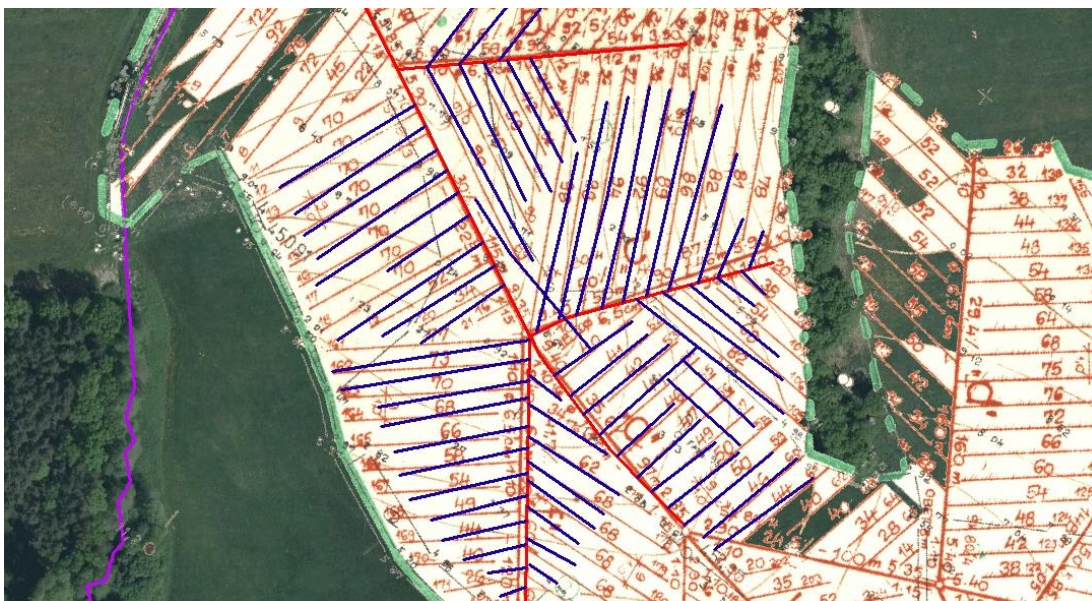
Obr. 23: Vektorizované linie odvodňovací soustavy z rastru ortofota a situace odvodňovací soustavy, [Zdroj: ČÚZK- Ortofoto, vlastní zpracování]
