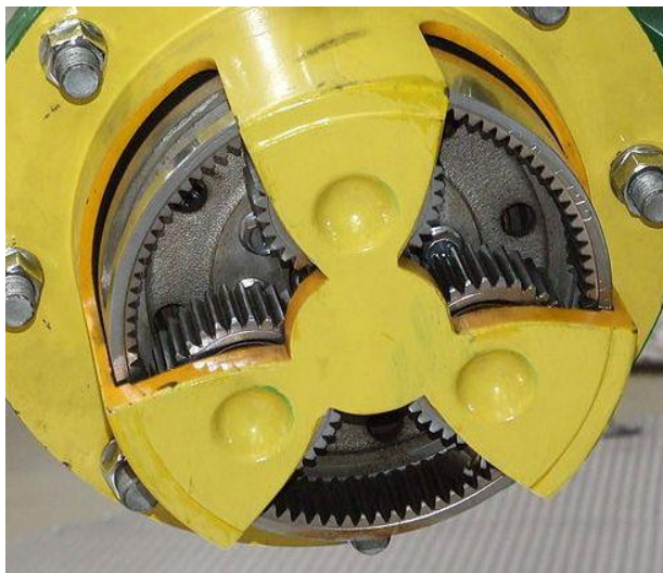
Obr. 3 řez planetového převodu [12]
